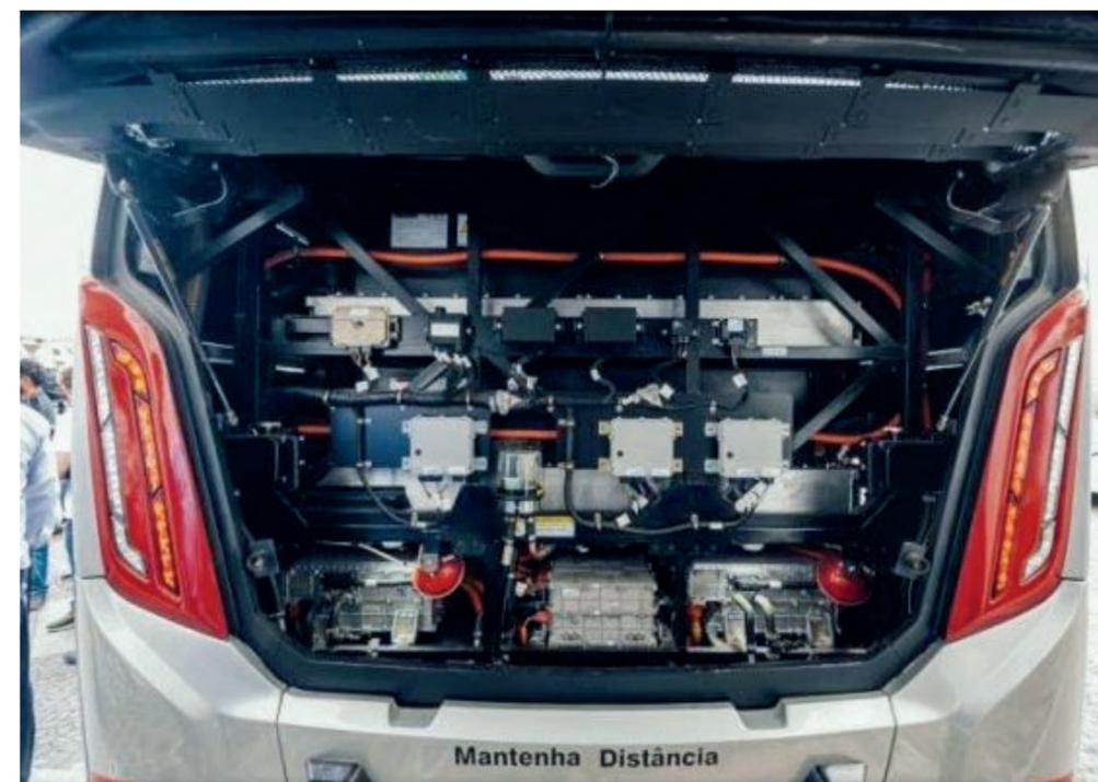
Espaço do conjunto de baterias e circuitos eletrônicos instalados em ônibus elétrico
