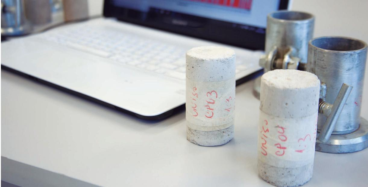
Corpos de prova produzidos no laboratório de Materiais de Construção Civil da Uniso
